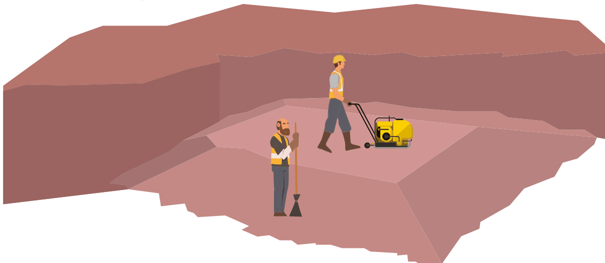
Figura 47. Compactación de celdas con rodillo y pistón manual.
