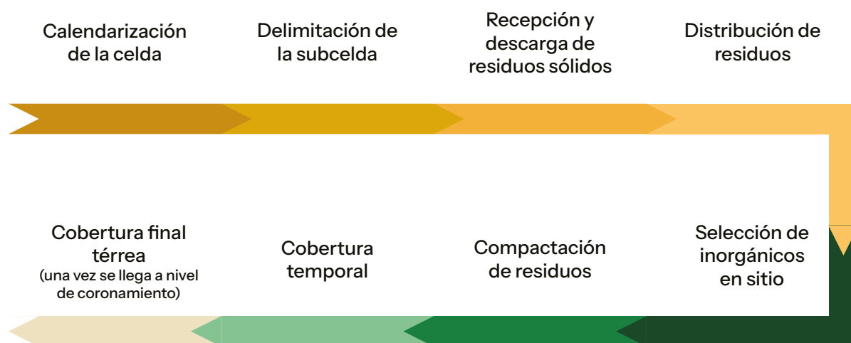
Figura 35. Pasos en la operación de celdas de un relleno sanitario manual.
