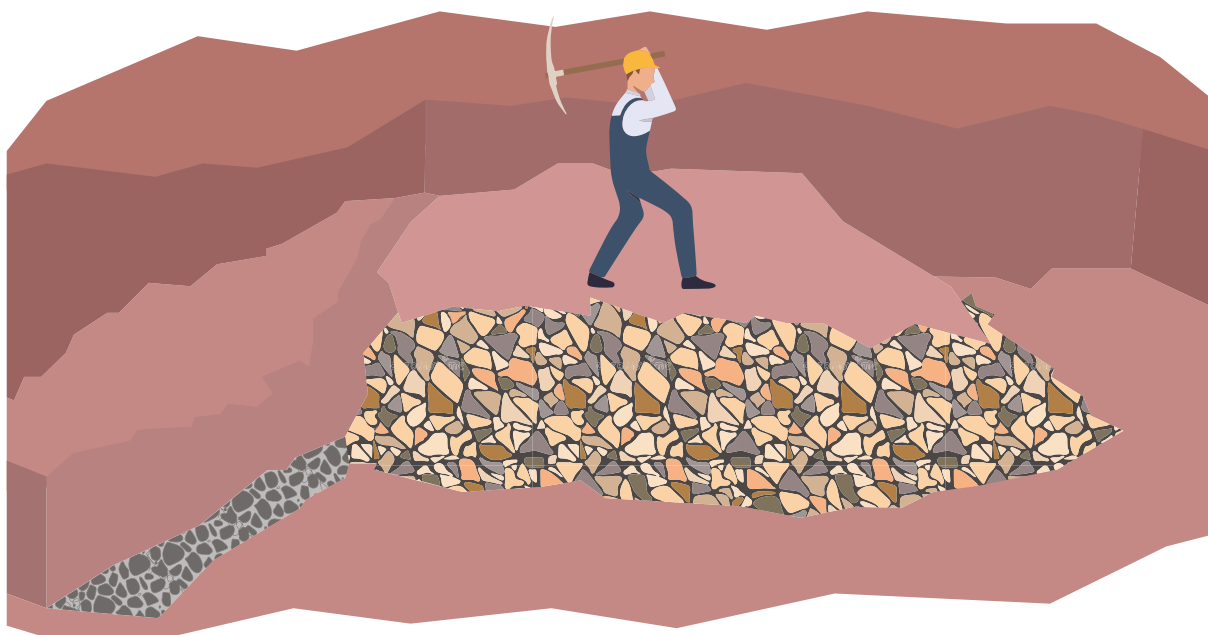
Figura 52. Extracción de material de cobertura para el cubrimiento de la celda.
